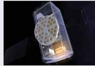
La précision suisse dans l'espace : dans les années 1990, l'ESA lance l'élaboration de deux types d'horloge de bord pour le futur système Galileo : les horloges au rubidium (Rubidium Atomic Frequency Standard, RAFS) et les horloges à hydrogène (Passive Hydrogen Maser, PHM). En 2005, le premier satellite d'essai Galileo est équipé d'horloges RAFS; le deuxième satellite d'essai GIOVE-B teste la première horloge PHM. © ESA
