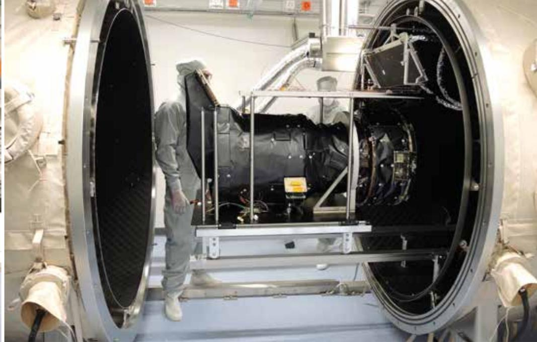
Le modèle structurel et thermique (STM) de CHEOPS au laboratoire de l'Université de Berne. A gauche, le satellite vu de face avec le baffle et, au-dessus, les radiateurs participant à la régulation de la température du télescope et du détecteur. A droite, le télescope est placé dans la chambre à vide thermique pour des tests environnementaux. © CHEOPS Team / Université de Berne
