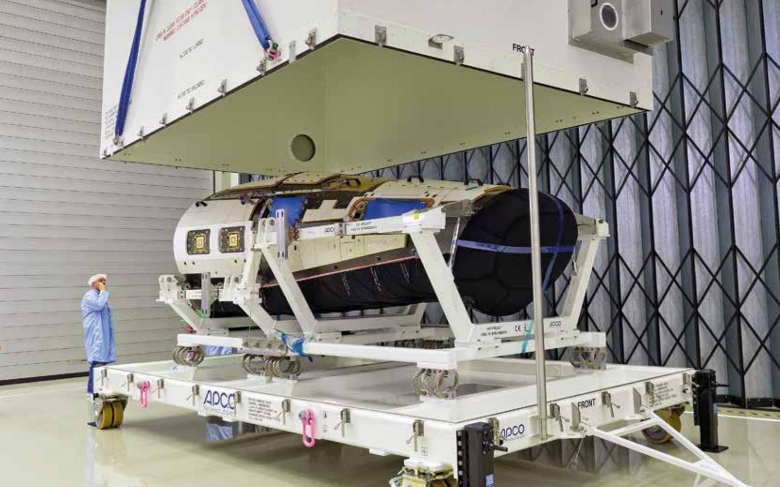
La structure de la navette européenne IXV (Intermediate eXperimental Vehicle) développée par RUAG Space, portée par le système mécanique sol d'APCO Technologies © ESA
