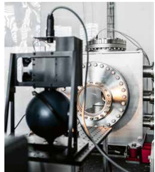
«Cleopatra» besteht aus einer Vakuumkammer, in der die Kameras unter Weltraumbedingungen getestet werden können.
