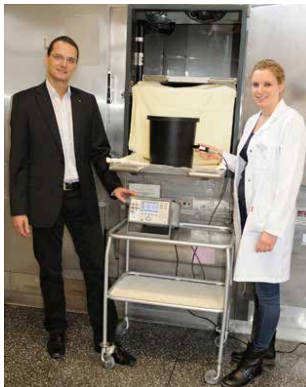
Christian Jackowski und Kristina Bauer zeigen, wie mit dem neuen Thermomessfühler die Temperaturdaten von auskühlendem Silikon gemessen werden. Silikon speichert und leitet Wärme ähnlich wie Wasser im Körper.
