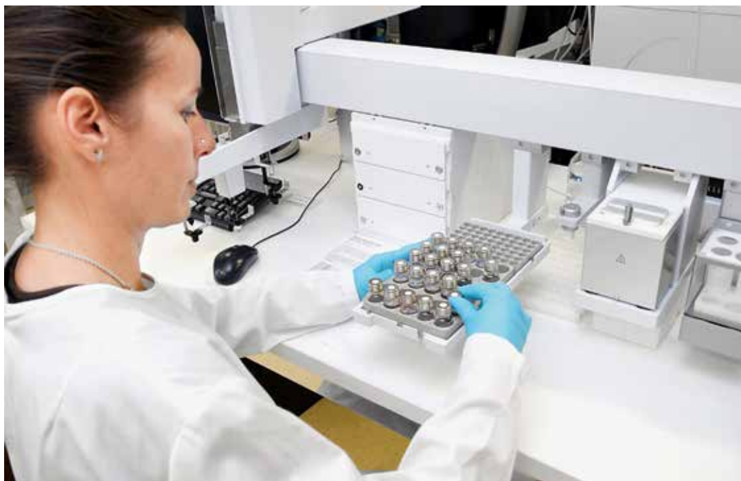
Das Massenspektrometrie- und Proteomics-Labor des Departements Klinische Forschung analysiert zentral für alle Forschungsgruppen Eiweisse. Hier werden Reagenzien auf einem «Liquid Handling Roboter» bereitgestellt.
