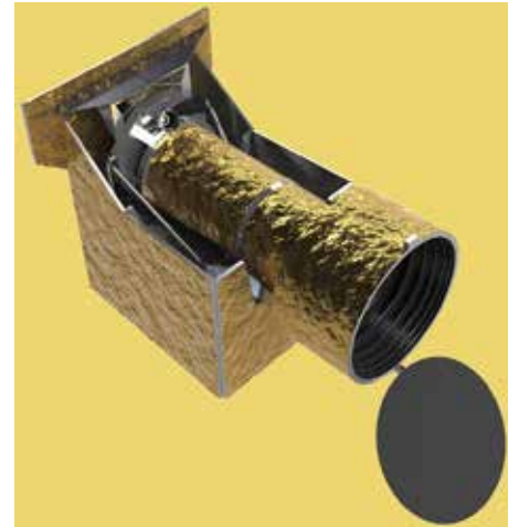
Der CHEOPS-Satellit ist ein Teleskop mit einem Durchmesser von 33 Zentimetern und 1,5 Meter Länge. Er wiegt rund 200 Kilogramm.
