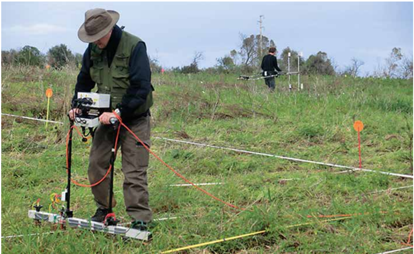
Das bis jetzt weitgehend unerforschte Hochplateau «Piano del Tamburino», über das sich ein Stadtteil Himeras erstreckte. Im Vordergrund führt ein Student eine elektrische Flächenkartierung, im Hintergrund ein Mitarbeiter eine geomagnetische Prospektion durch.
