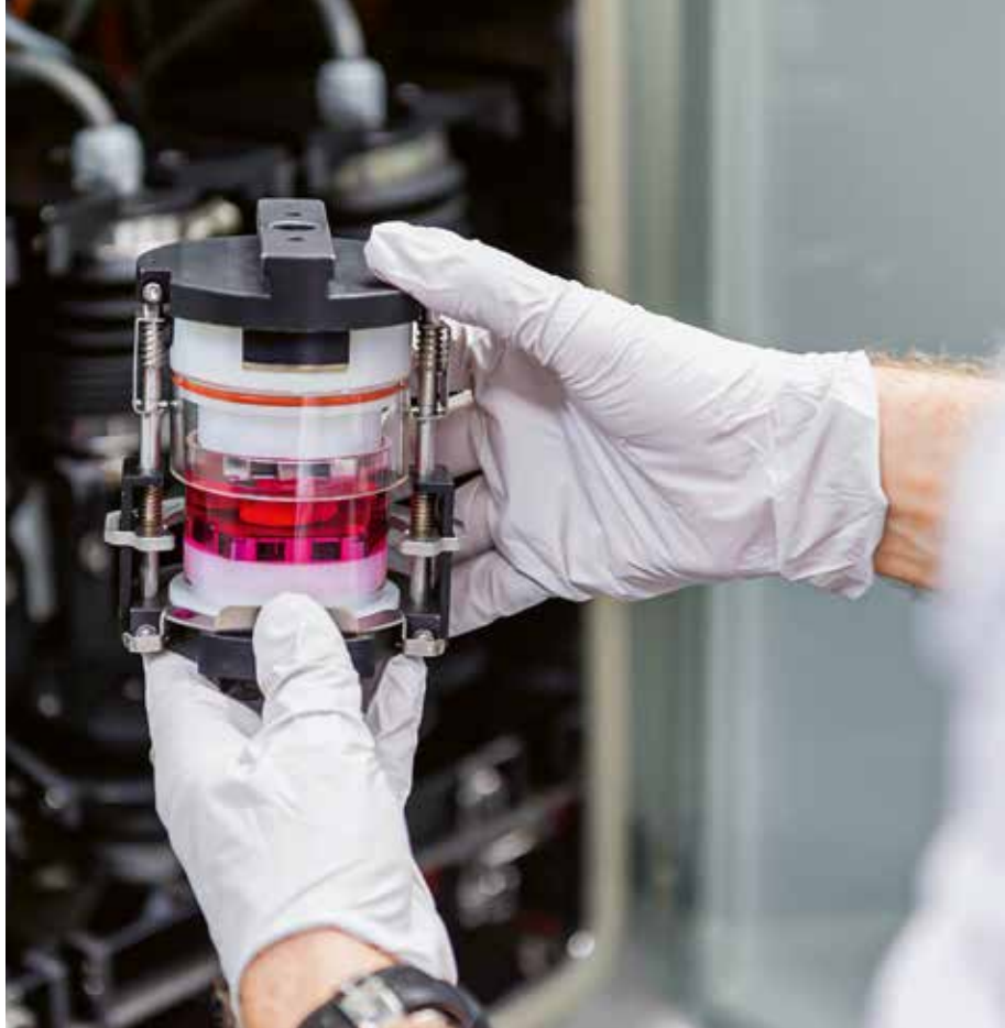
Im Bioreaktor können Belastungen auf die Bandscheibe simuliert und die darauffolgenden Reaktionen untersucht werden. (Bilder ©: Ramon Lehmann)
