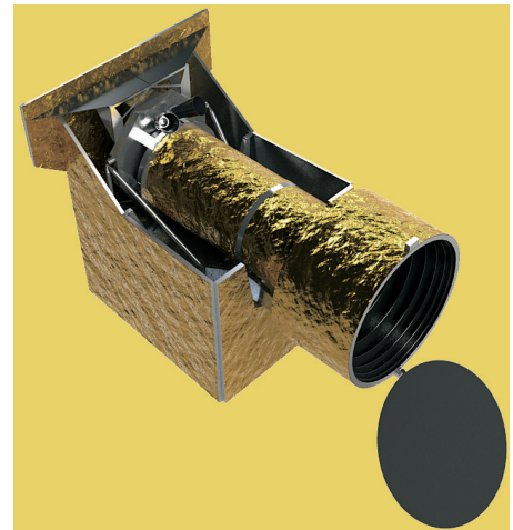
Der CHEOPS-Satellit ist ein Teleskop mit einem Durchmesser von 33 Zentimetern und 1,5 Meter Länge. Er wiegt rund 200 Kilogramm. © Swiss Space Center, EPFL
