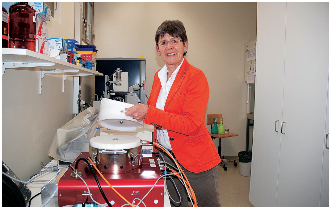
Angriff der Nanopartikel durch die Schläuche: In dieser In-vitro-Kammer untersucht Professorin Marianne Geiser, wie Lungenzellen auf Kleinstteilchen reagieren. (© Susanne Wenger)
