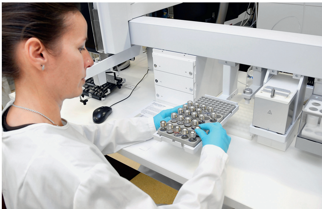
Das Massenspektrometrie- und Proteomics-Labor des Departements Klinische Forschung analysiert zentral für alle Forschungsgruppen Eiweisse. Hier werden Reagenzien auf einem «Liquid Handling Roboter» bereitgestellt. © Departement Klinische Forschung, Universität Bern
