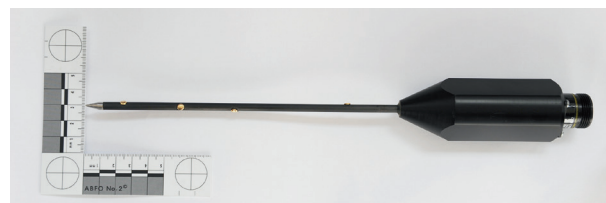
Mit dem Prototyp des hochsensiblen Thermomessfühlers werden derzeit Daten gesammelt. Ziel ist es, ein portables Messgerät zu entwickeln, um den Todeszeitpunkt präzise und gleich am Auffindungsort einer Leiche zu bestimmen.
