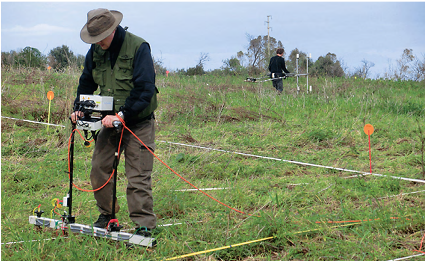
Das bis jetzt weitgehend unerforschte Hochplateau «Piano del Tamburino», über das sich ein Stadtteil Himeras erstreckte. Im Vordergrund führt ein Student eine elektrische Flächenkartierung, im Hintergrund ein Mitarbeiter eine geomagnetische Prospektion durch. (© IAW, Universität Bern)
